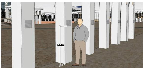
В столбах галерей будут смонтированы кондиционеры воздуха. Выходные отверстия для охлаждённого воздуха будут сделаны на высоте 1440 мм от земли, с внутренней стороны галерей. Электроэнергию кондиционеры будут получать от солнечных батарей на крыше галерей, в столбах галерей будут находиться аккумуляторы.
