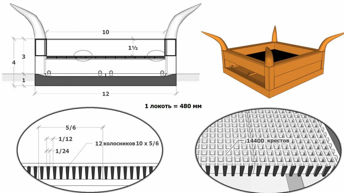
Колосники размером  $2,4 \times 2,4$  м очень тяжелы, поэтому они состоят из 12 секций.
